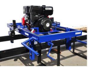
Кромкообрезной станок «КЕДР», оснащенный двигателем внутреннего сгорания, позволяет использовать оборудование в тех регионах страны, где имеются проблемы с подачей электроэнергии.
