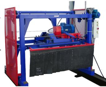
В процессе рабочего хода вращающийся диск пропиливает древесину на заданную глубину, потом его перемещают на направляющих, и в процессе обратного хода выполняется очередной пропил. Есть несколько способов распиловки, при которых из цилиндрического бревна получают доски и брус нескольких типоразмеров. Пилорама работает в ручном режиме. Положение дисковой пилы регулирует оператор при перед каждым рабочим ходом.
