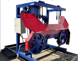
Данный ленточнопильный станок оснащен электромеханической системой подъема пилы, что делает позиционирование пильной каретки простым и быстрым, позволяя регулировать положение пропила с эффективностью, недоступной моделям КЕДР и КЕДР-1 без электроподъемника.
