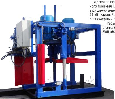
Дисковая пилорама горизонтального пиления КЕДР-ДП2 комплектуется двумя электродвигателями по 11 кВт каждый. Они осуществляют равномерный пропил бревна.
